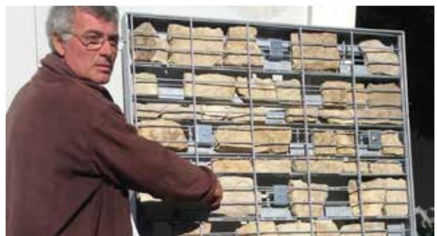
Prototype du gabion de façade en pierres de réemploi.
